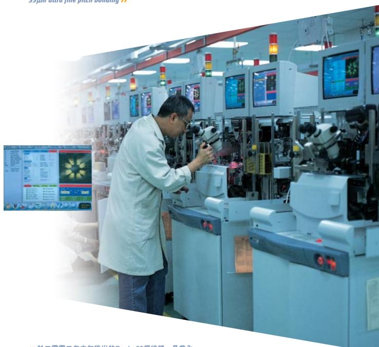
« 於二零零二年中旬推出的Eagle 60焊線機 ,是業內 首部可作35μm微距焊線的焊線機 >>
