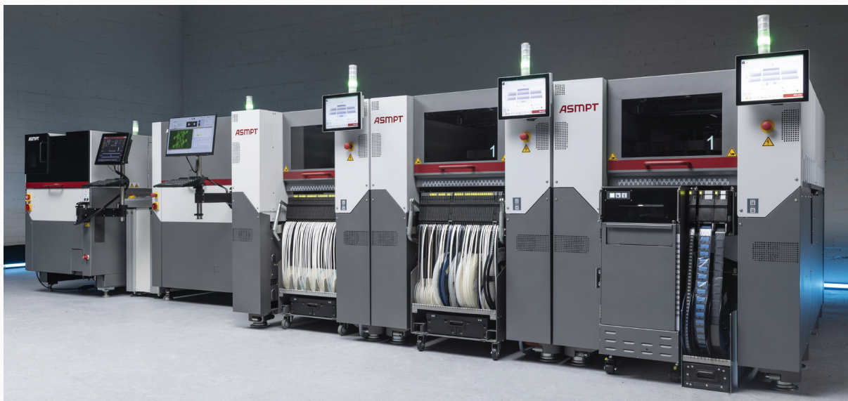
SIPLACE V貼裝平台：新一代性能，提升精度、流程穩定性，以及空間與物料的高效運用。
